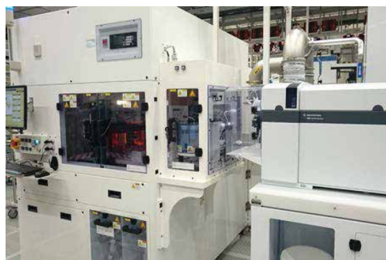
IAS Inc. 製 Expert PS 全自動 VPD-ICP-MS システムと Agilent 8800 ICP-MS/MS の組み合わせ。 写真は ST Microelectronics (クローレ、フランス) が提供
